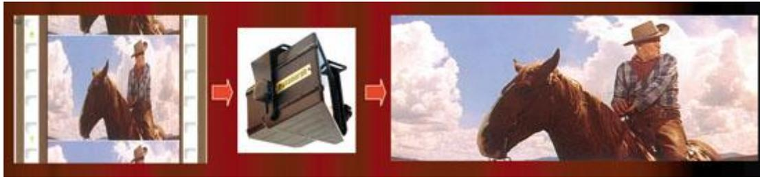
要实现 16:9 向 2.35:1 的图像过渡，原理并不复杂，实际上就是在保证投影影像面积不变的情况下，先利用投影机内部处理芯片或者外置处理器将画面进行垂直拉长，使得影像上下方的黑边消失，再将变形镜头放置于投影机前方，将画面水平拉伸或垂直挤压，最终完成 2.35:1 的影像变换。在配合变形镜头的使用过程中，通常情况下都要对屏幕进行遮盖。如果采用的是 16:9 的屏幕，就需要采用上下遮幅的方式；如果是直接使用 2.35:1 的屏幕，就需要采用左右遮幅的方式。
