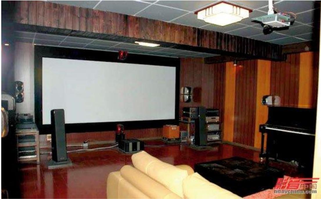
**选择怎么样的比例的投影幕应该从房间的结构入手，对于宽高比越大的房间就越适合安装 2.35:1 的投影幕，因为这样能得到最大的画面利用率**
